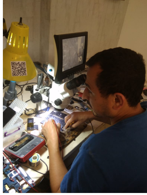
Şəkil 2.30. AK-17 markalı mayekristal ekranlı binokulyar mikroskopla platanın yoxlanılması
