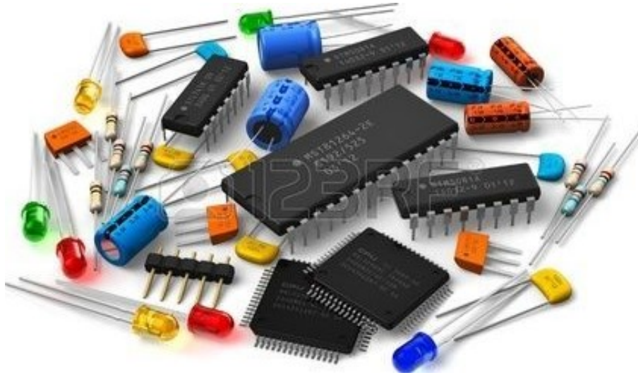
Şəkil 2.15. Rezistorlar, tranzistorlar, kondensatorlar, işıq diodları (yaşıl, qırmızı, sarı və mavi) və mikrosxemlərin təsviri
