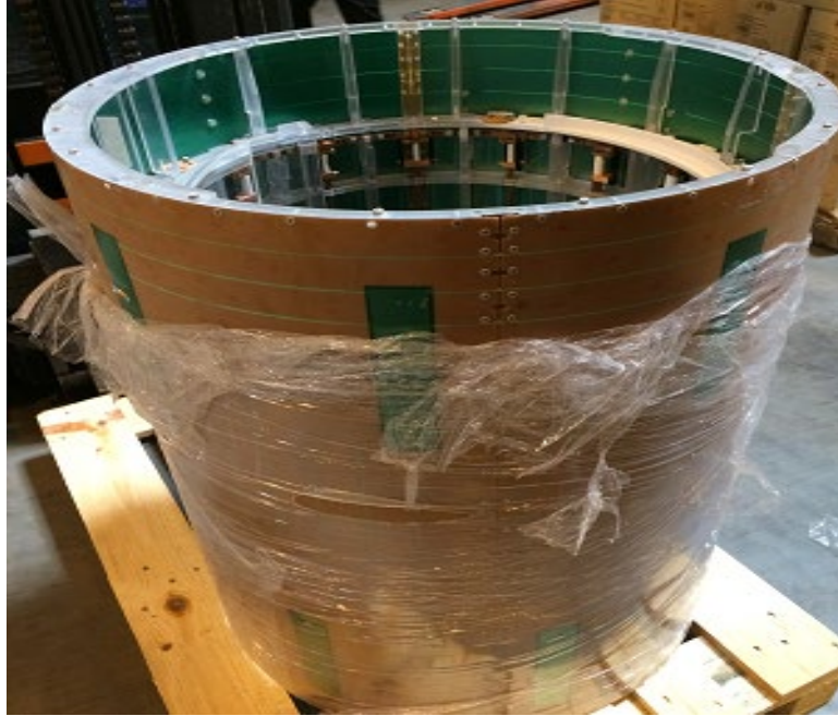
Ş kil 2.4. Body Coil tipli b d ni vizuallaşdıran sarğac
