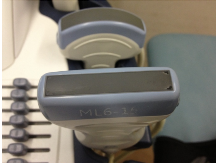
 kil 2.11. Ultras s m yain  aparatının al aq v  y ks k tezlikli vericil ri
